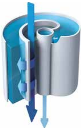
Ilustração da passagem do fluxo em uma membrana de OR avançada, que está inserida em um cartucho. O fluxo tangencial limita o risco de incrustação.
